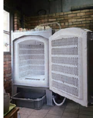
窯業に使用する電気窯
